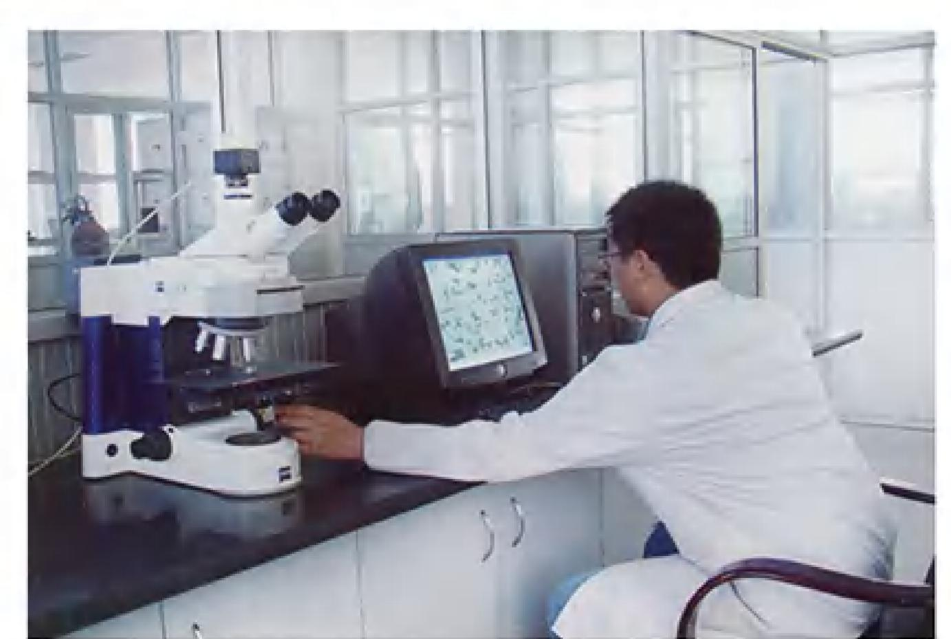
金相显微镜 Metallographic Microscope
