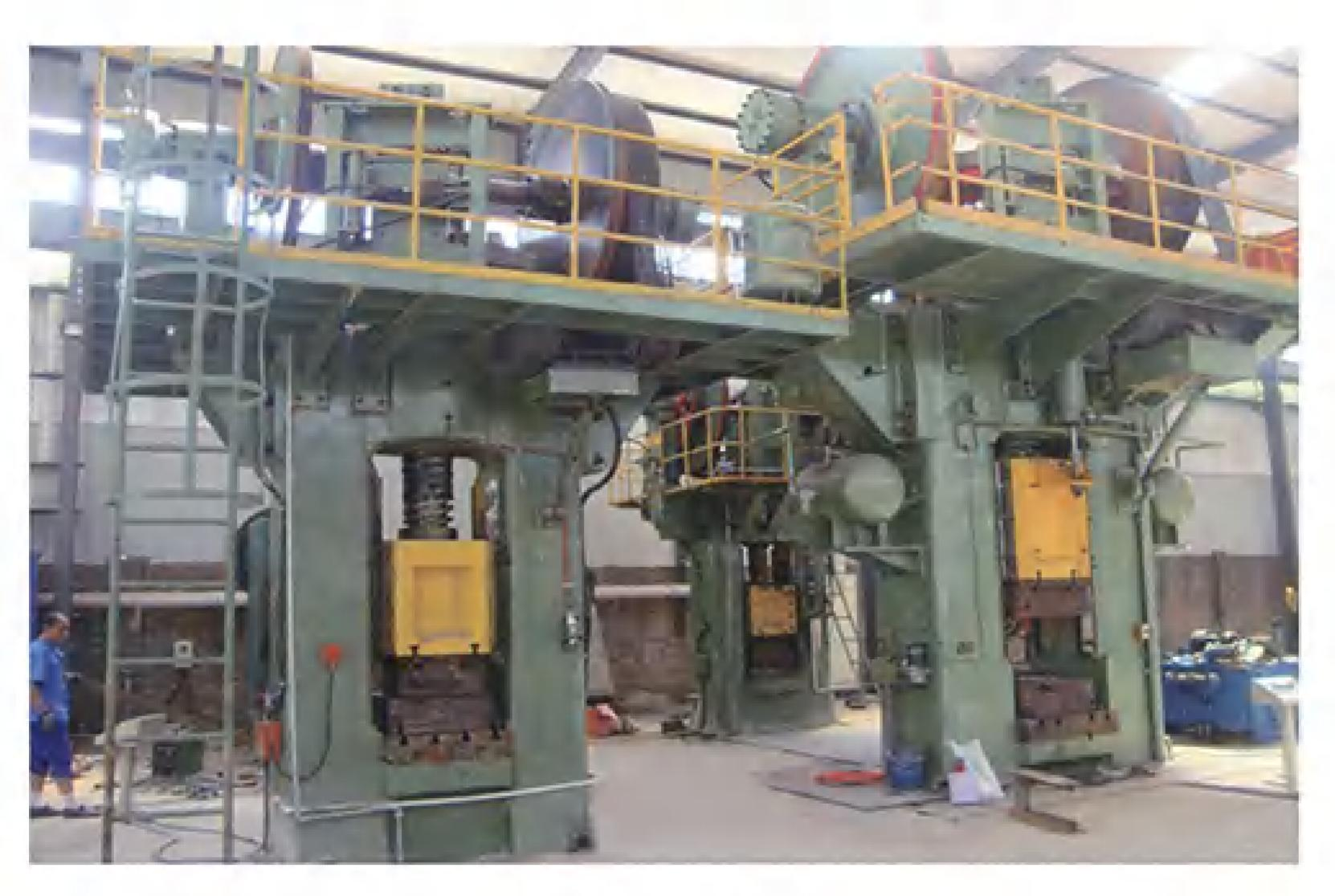
摩擦压力机 Friction presses
