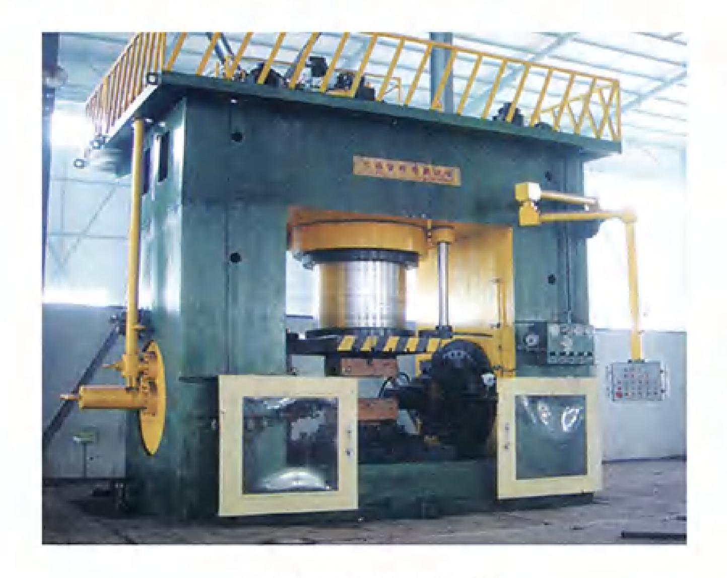
三通冷挤压成型设备 Cold extrusion machine for Tee
