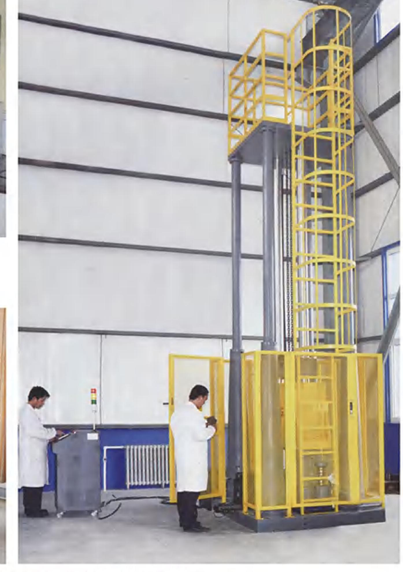
ZCJ2504落锤撕裂试验机 ZCJ2504 DWTT Machine
