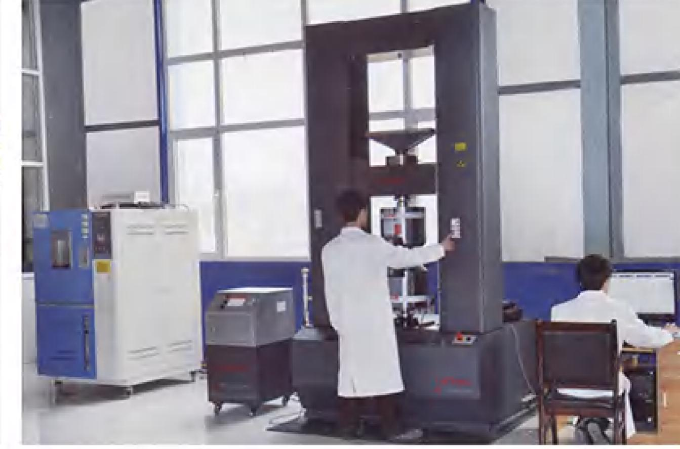
MTS 600KN 微机控制电子万能试验机 MTS 600KN Electromechanical Universal Testing Machine
