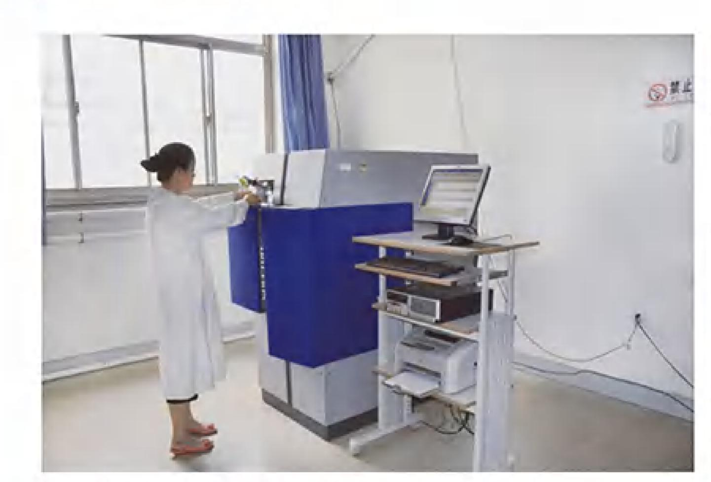
德国斯派克M9直读光谱仪 Germany SPECTRO M9 Direct Reading Spectrometer
